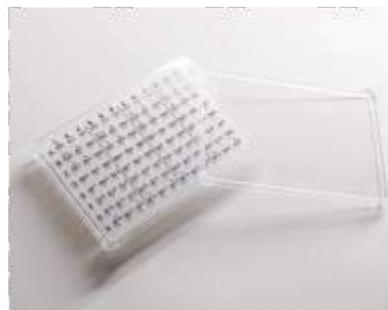
Крышки для микропланшетов удобные в работе, обеспечивают защиту от загрязнения, выпаривания при проведении анализа. По желанию крышки изготавливаются любого цвета, из любого материала, стерильные и нестерильные, а также с нанесением логотипа, линейки и других надписей.
